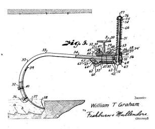
40까지)가 쟁기를 끄는 I 빔 장치(옆 도면에서 3, 29 와 30)와 독립적으로 위로 움직일수 있도록 설치대의 한쪽에 쟁기를 핀(옆도면에서 64)을 꽂아 연결하여 설치대의반대편에는 스프링(옆도면에서 66)을 연결하여 쟁기가 돌에 부닥치면 위로 움직일수있게 하고, 스프링의 힘으로 쟁기가 다시 원위치로 돌아가게 하는 받침대로 1950년
